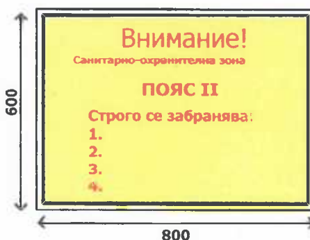
Предупредителна табела за пояс II на санитарно- охранителната зона
