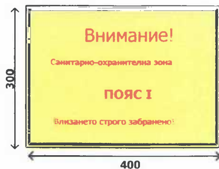
Предупредителна табела за пояс I на санитарно- охранителната зона
